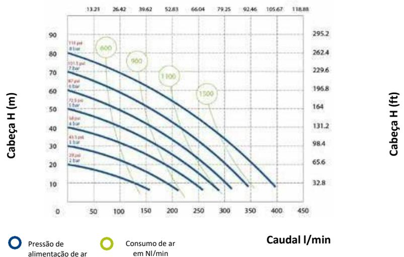
As curvas e os valores de desempenho referem-se a bombas com aspiração submersa e saída de descarga livre com água a 20°C. e variam consoante o material de construção.
