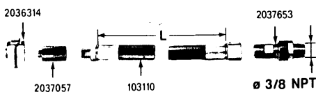
Conjunto Cod. 0101840 – Flex Ø 10x22 com porta para botão de cabeça. Tipo gigante
