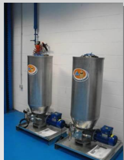
SUMO ATEX 316: версия с насосными элементами, распределители давления и бак из нержавеющей стали 316 .
