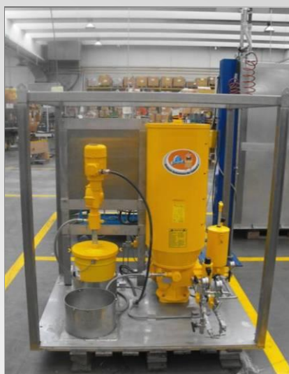
SUMO 100 кг с персонализированным желтым покрытием, установлен на стальном поддоне 316 и включает систему ручного управления PLC и электрический насос для бочек для заполнения.
