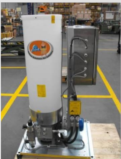
SUMO с полупрозрачным баком, реле давления в конце линии и панель управления из нержавеющей стали установлены на стандартном поддоне.
