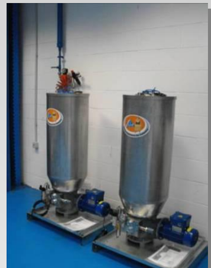
Bomba SUMÔ padrão ATEX com reservatório em aço inox 316 e motor classe Ex (d).
