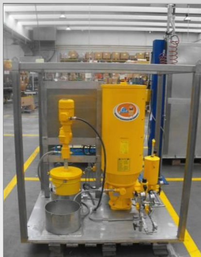
Bomba SUMÔ de 100 Kg com pintura amarela, montada sobre uma base especial em aço inox 316, com painel de controle tipo PLC, bomba elétrica para reabastecimento e bomba manual de emergência.
