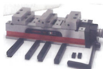
Doppia morsa autobloccante con possibilità di chiudere i due pezzi contemporaneamente con tolleranza fino a 2 mm
