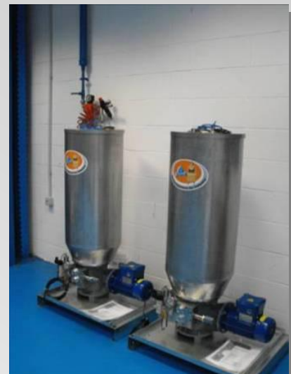
SUMO ATEX 316: versión con cuerpos bombantes, distribuidores de presión y depósito en Inox 316 .
