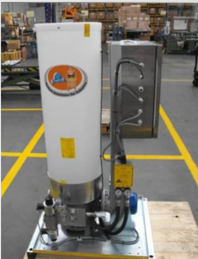
Bomba SUMO con depósito semi-transparente presostato final de línea y panel de control en caja de INOX montado sobre una placa estándar.
