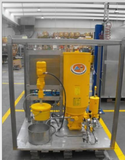
Bomba SUMO 100 kg con recubrimiento personalizado en color amarillo y montada en placa de acero 316 con sistema manual de control PLC y bomba eléctrica de caña para el llenado.
