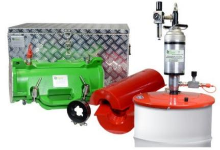
**Viper Mini MK 3** 使润滑脂能够渗入钢丝绳，确保润滑脂完全浸润钢丝绳。吊环使用高强度铝合金制造，表面涂层坚固，可最大限度地提高在恶劣环境中的耐腐蚀性。Viper WRL 能够润滑移动式起重机、塔式起重机、甲板绞车、建筑和服务起重机、锚索和小型船用起重机的钢丝绳。适用钢丝绳直径 **6mm - 44mm**。
