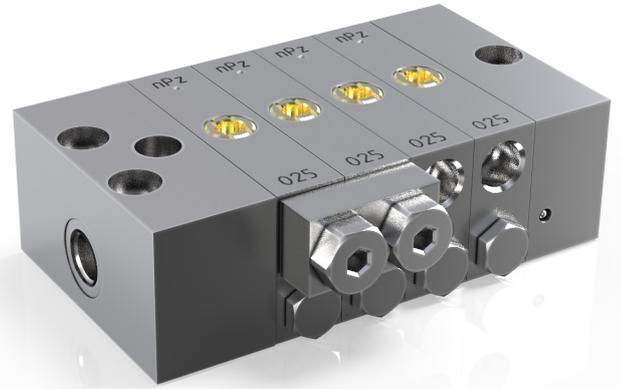
DropsaVET NPZ ist ein Verteiler, der die progressive Bewegung der Kolben nutzt, um präzise Schmiermittelmengen an mehrere Schmierpunkte abzugeben.
