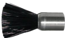
2049009 Setole 1/8BSP/F/P Lunghe 35 mm, 17 mm Ø Lunghezza complessiva 60 mm
