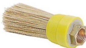
K001011 1/4 BSP/F/P com cerdas comprimento 40 mm - Ø 20 mm comprimento total 70 mm
