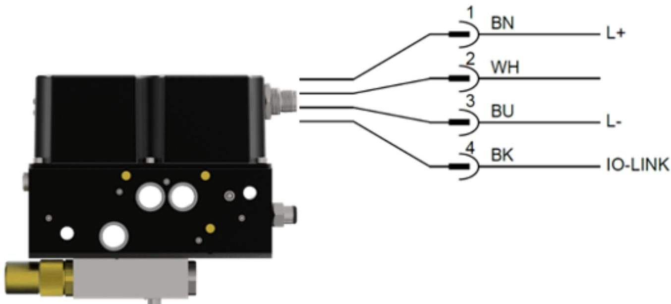
Brancher à l'aide d'un câble avec connecteur M12, le dispositif uniquement à un dispositif IO-Link master. N'importe quel autre type de branchement peut endommager le dispositif.
