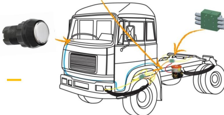
Система дистанционного управления - для полного контроля над системой смазки.
