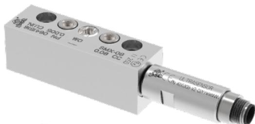
设计 UltraSensor 2 传感器的目的是替代接近开关传感器、机械微动开关和磁性接触器，从而监控递进系统分配器元件内部的活塞运动。该传感器是一个旋入式配件（安装在分配器一侧），无需对分配器进行任何更改。这是一项专利技术，通过一个霍尔效应传感器，能够在活塞到达检测区时监控到磁通量的变化。其不存在运动部件，因此完全没有损耗。
