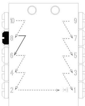
A vazão de saídas adjacentes podem ser combinadas tapando uma ou mais saídas. No exemplo, tapando a saída n.º 8 o lubrificante passa para a saída adjacente (no exemplo a número 6) por ordem decrescente. No caso de ser tapada a saída n.º 2 o lubrificante passa para a saída n.º 1.
