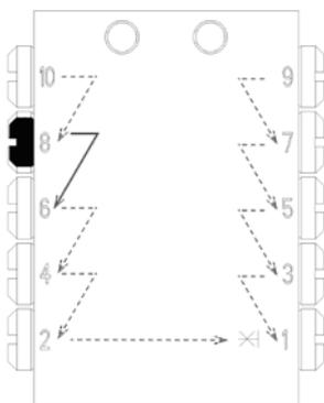
Le portate di uscite adiacenti possono essere combinate tappando una o più uscite. Nell'esempio tappando l'uscita n. 8 il lubrificante passa all'uscita adiacente (nell'esempio la numero 6) in ordine decrescente. Nel caso in cui venga tappata l'uscita n.2 il lubrificante passa all'uscita n. 1.
