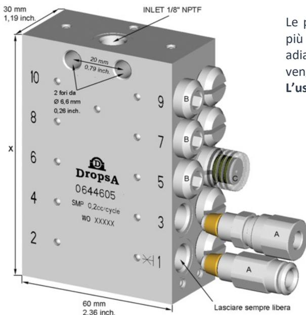
Le portate di uscite adiacenti possono essere combinate tappando una o più uscite. Nell'esempio tappando l'uscita n. 8 il lubrificante passa all'uscita adiacente (nell'esempio la numero 6) in ordine decrescente. Nel caso in cui venga tappata l'uscita n.2 il lubrificante passa all'uscita n. 1.
